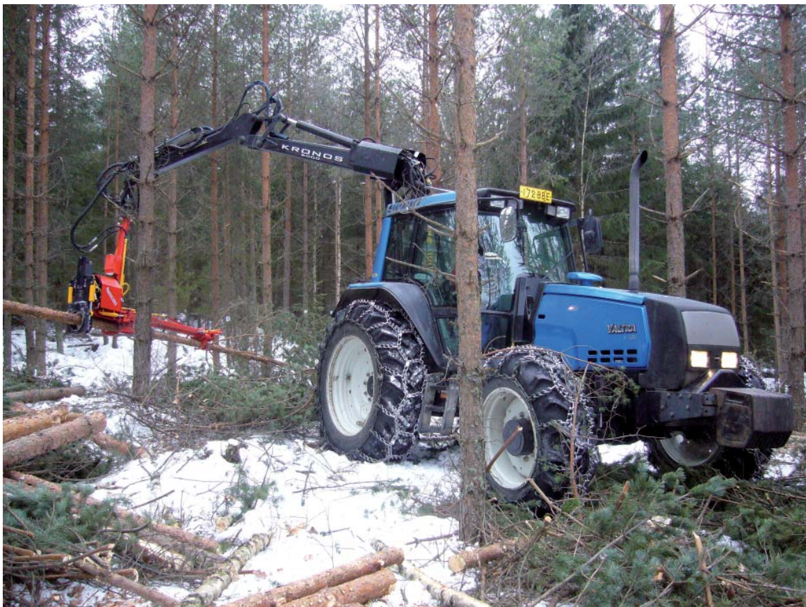
Kuva 3. Tutkittu koneyhdistelmä tutkimustyömaalla. Peruskoneessa oli etuakselin vakaaja ja 300 kg etupainoja. Öljyn tuotto 60 cm 3 :n keulapumpulla oli 84 litraa minuutissa traktorin moottorin kierrosten ollessa 1400 minuutissa.
