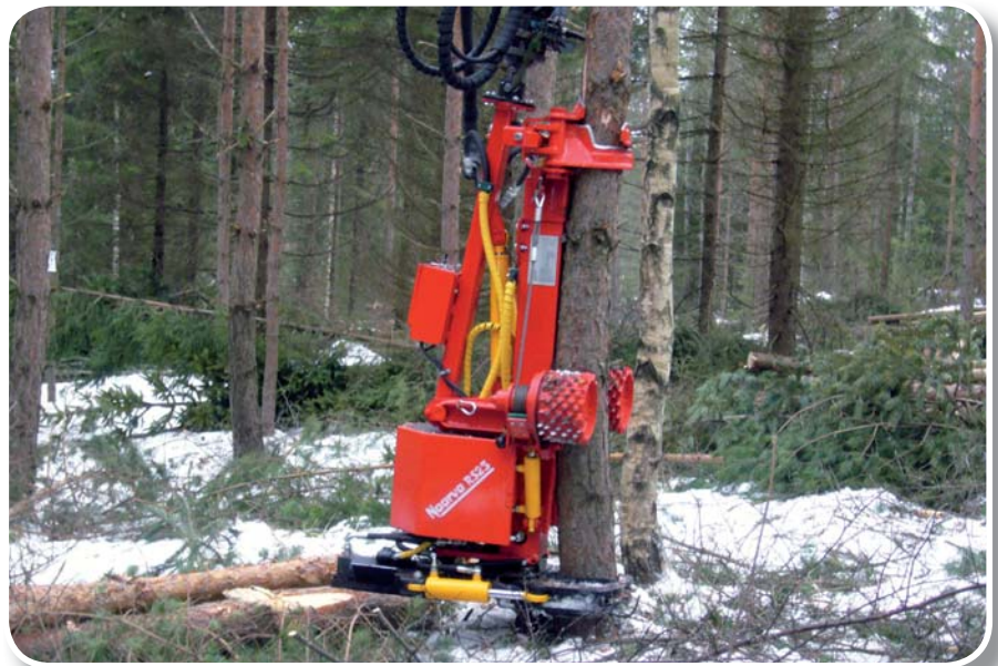
Kuva 1. Naarva RS25 -rullasykeharvesterissa katkaisugiljotiinin kypälien 25 cm:n kokonaiskorkeus ja 15 cm korkeat syöttörullat antavat puun rungolle liikkumavaraa, joten kohtuullisen mutkaisenkin puun käsittely käy paremmin.
