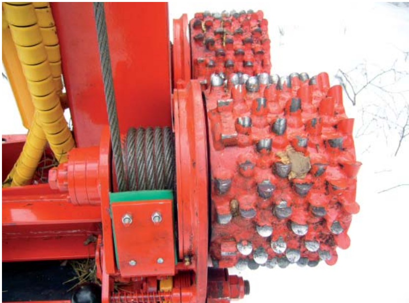
Kuva 2. Syöttöruullia pyörittävät vaijerit kelautuvat uritetulle kelalle. Näin syöttövoima ja -pituus pysyvät joka rullan kierroksella vakiona.
